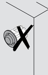
N'utilisez aucune butée car celle-ci limite la fonction de déclenchement.
