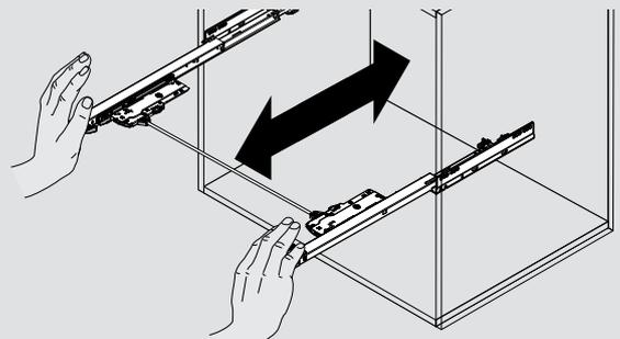
Ouvrir parallèlement les coulisses corps de meuble avec la synchronisation clipsée, ou fermer afin que l'embout de tube de synchronisation ne soit pas endommagé.
