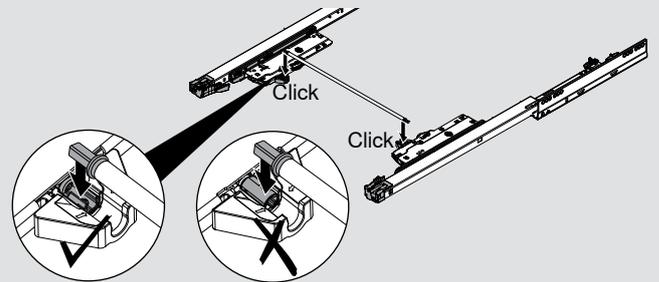
Pour une fonction optimale et pour optimiser la zone de déclenchement de TIP-ON BLUMOTION, utilisez un axe de synchronisation.
