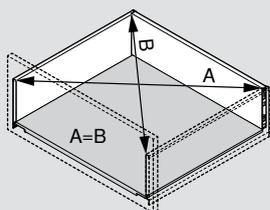
Une mise en œuvre précise du jeu de façade de 2.5 mm est nécessaire. Pour cela, respectez les cotes planifiées et l'exactitude des angles.
