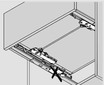
c) l'entraîneur ne doit pas être monté sur la coulisse corps de meuble pendant le transport.
