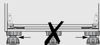
Ne primjenjujte prigušivač jer on ograničava isključnu funkciju. Dno korpusa ne smije se savijati prema gore, stoga nemojte primjenjivati peto podnožje.
