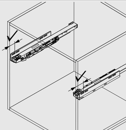
Obratite pažnju na točnu dubinu obiju vodilica koje se pričvršćuju na korpus.
