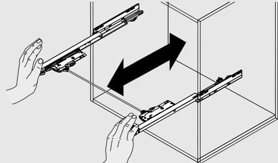
Kod sustava LEGRABOX / MOVENTO: Vodilice koje se pričvršćuju na korpus s postavljenom sinkronizacijom paralelno otvorite ili zatvorite kako se adapter za sinkroniziranje ne bi oštetio.
