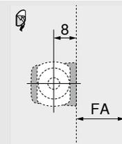
\* Kod magnetne pločice sa vijkom preporučujemo pomeranje pozicije TIP-ON za 3 mm.
