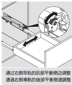
通过右侧导轨的后部平衡侧边调整
