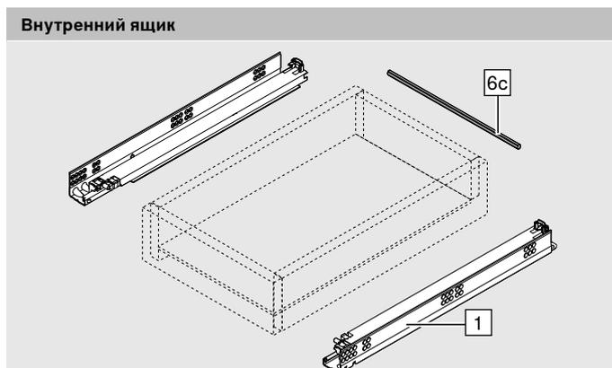
561F – монтаж на фиксаторы – полное выдвижение – встроенный TIP-ON
