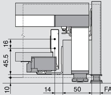
Cotes de perçage de la face pour EXPANDO
