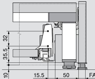
Cotes de perçage de la face pour EXPANDO
