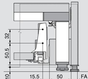
Cotes de perçage de la face pour EXPANDO
