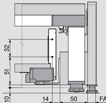
Cotes de perçage de la face pour EXPANDO
