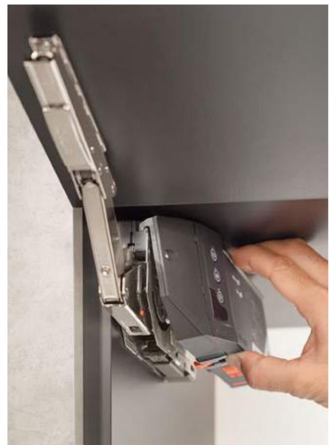
A pesar de su volumen reducido, el nuevo compás abatible **SERVO-DRIVE para AVENTOS HK top** ofrece una convincente funcionalidad. Gracias al mecanismo CLIP, el montaje del equipo de accionamiento se realiza sin herramientas como Add-on en el mecanismo de elevación de AVENTOS HK top.
