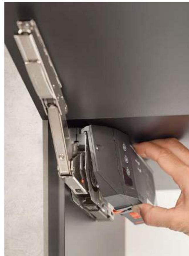
Der neue Klappenbeschlag **SERVO-DRIVE für AVENTOS HK top** bietet trotz geringen Volumens überzeugende Funktionalität. Dank CLIP-Mechanismus erfolgt die Montage der Antriebseinheit werkzeuglos als Add-on auf dem Kraftspeicher von AVENTOS HK top.
