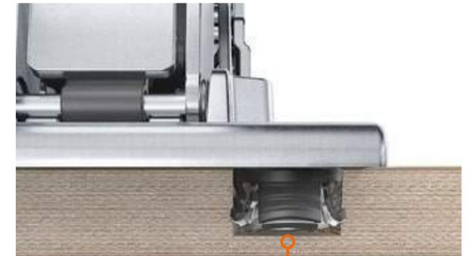
Zuganker aus Stahl sorgen für festen Halt in harten Materialien, Kunststoffbacken stellen den Halt in weichen Materialien sicher. **EXPANDO T** wird in einer Bohrung mit 10 mm Durchmesser und einer Bohrtiefe von nur 6 mm befestigt.
