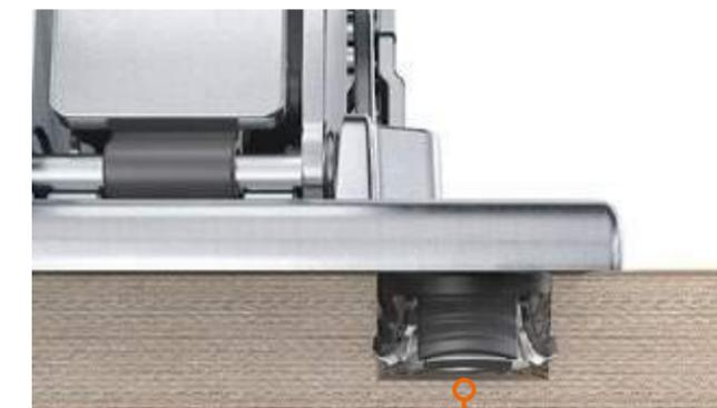
Tirantes em aço permitem posição firme em materiais duros; e mordedores em matéria plástica asseguram a firmeza em materiais moles. A bucha **EXPANDO T** é fixada em uma furação com um diâmetro de 10 mm e uma profundidade de furo de apenas 6 mm.
