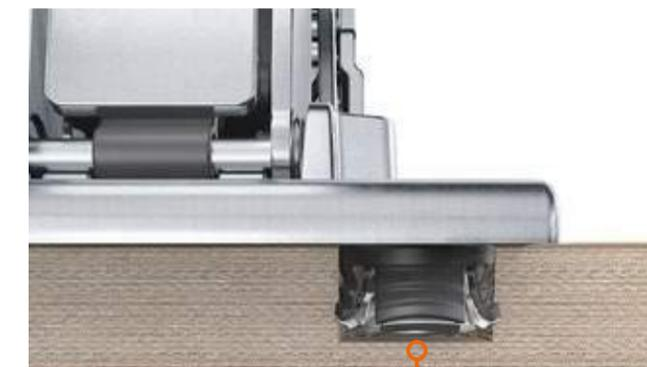
Les ancrages en acier permettent un maintien solide dans les matériaux durs, les mâchoires en matière plastique garantissent un maintien sûr dans les matériaux tendres. **EXPANDO T** est fixé dans un perçage de 10 mm de diamètre et avec une profondeur de perçage de seulement 6 mm.
