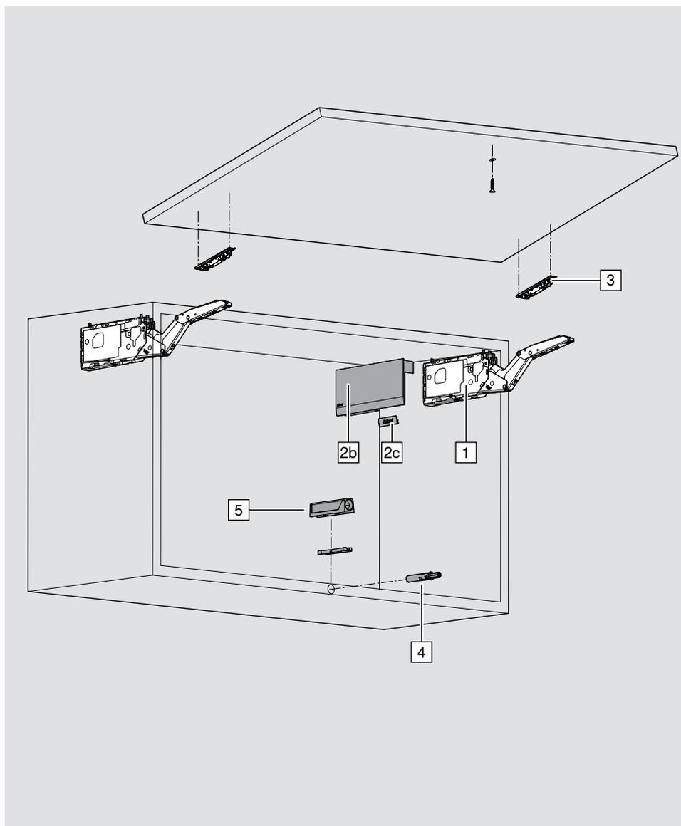
Le facteur de puissance vous permet de déterminer le réservoir de force nécessaire. Le facteur de puissance dépend du poids de la face (inclus le double du poids de la poignée) et de la hauteur du corps.
