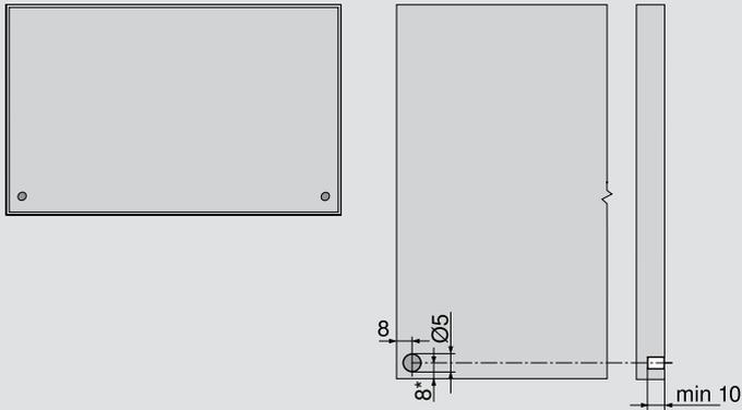
Recommandation pour cadre aluminium : prévoir un perçage pour la butée de distance Blum dans le côté du corps de meuble. Pour la fixation de la butée de distance Blum, effectuer un essai de montage dans la face.
