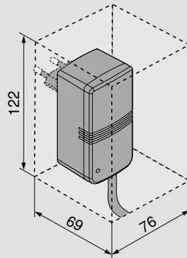
**i** Pour la circulation de l'air, respecter une distance de sécurité de 30 mm (voir schéma). Dans le cas contraire, il y a un risque de surchauffe de l'alimentation Blum ou du bloc d'alimentation réseau Blum.
