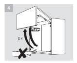
La face s'ouvre et se ferme 2x automatiquement: en aucun cas intervenir pour interrompre ou stopper la procédure.
