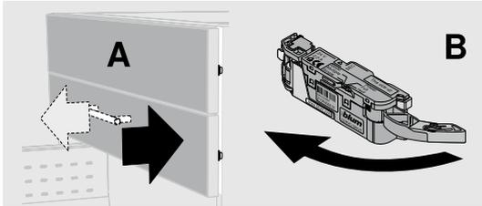
Por meio da tração ou pressão na frente ou no puxador da gaveta (A), a alavanca ejetora do mecanismo de acionamento (B) realiza um movimento oscilatório para a frente, fazendo com que a gaveta deslize um pouco para fora.
