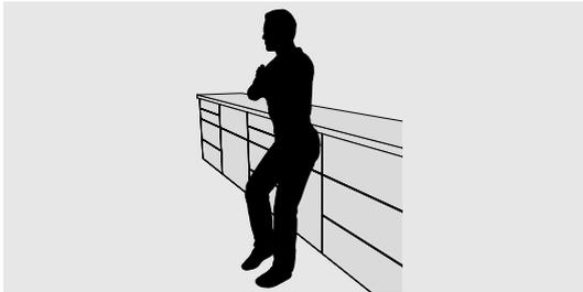
A função eletrônica de abertura é ativada apenas com um leve toque ou tensão. Se você se apoiar na gaveta, ela não se abrirá.
