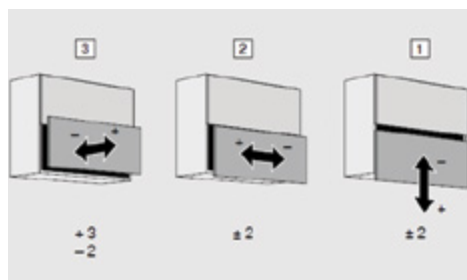
Điều chỉnh khoảng hở cánh bên dưới
