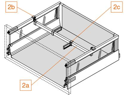
**i** Querreling nicht in Kombination mit Zwischenwand einsetzbar!
