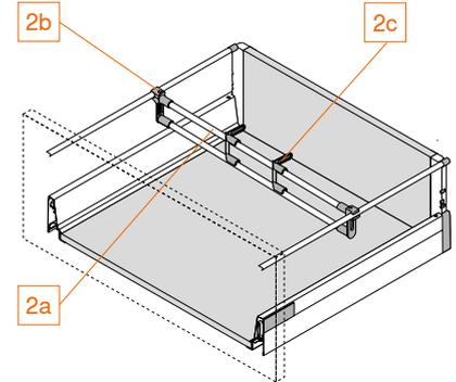
**i** Querreling nicht in Kombination mit Zwischenwand einsetzbar!
