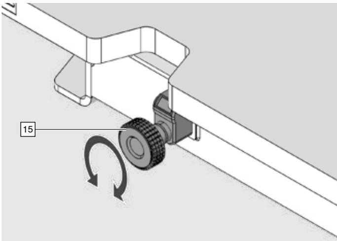
Drehgriff Einbohrtiefe [15] Horizontalbohrung.
