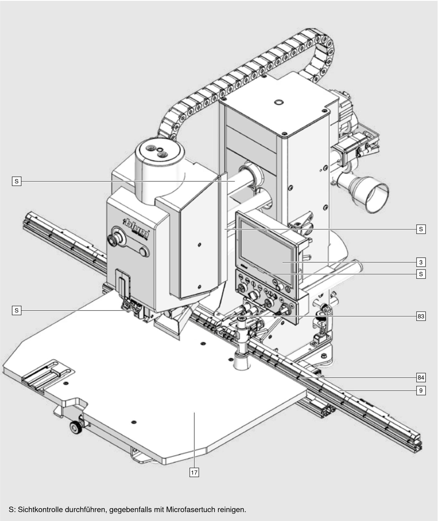
S: Sichtkontrolle durchführen, gegebenenfalls mit Microfasertuch reinigen.
