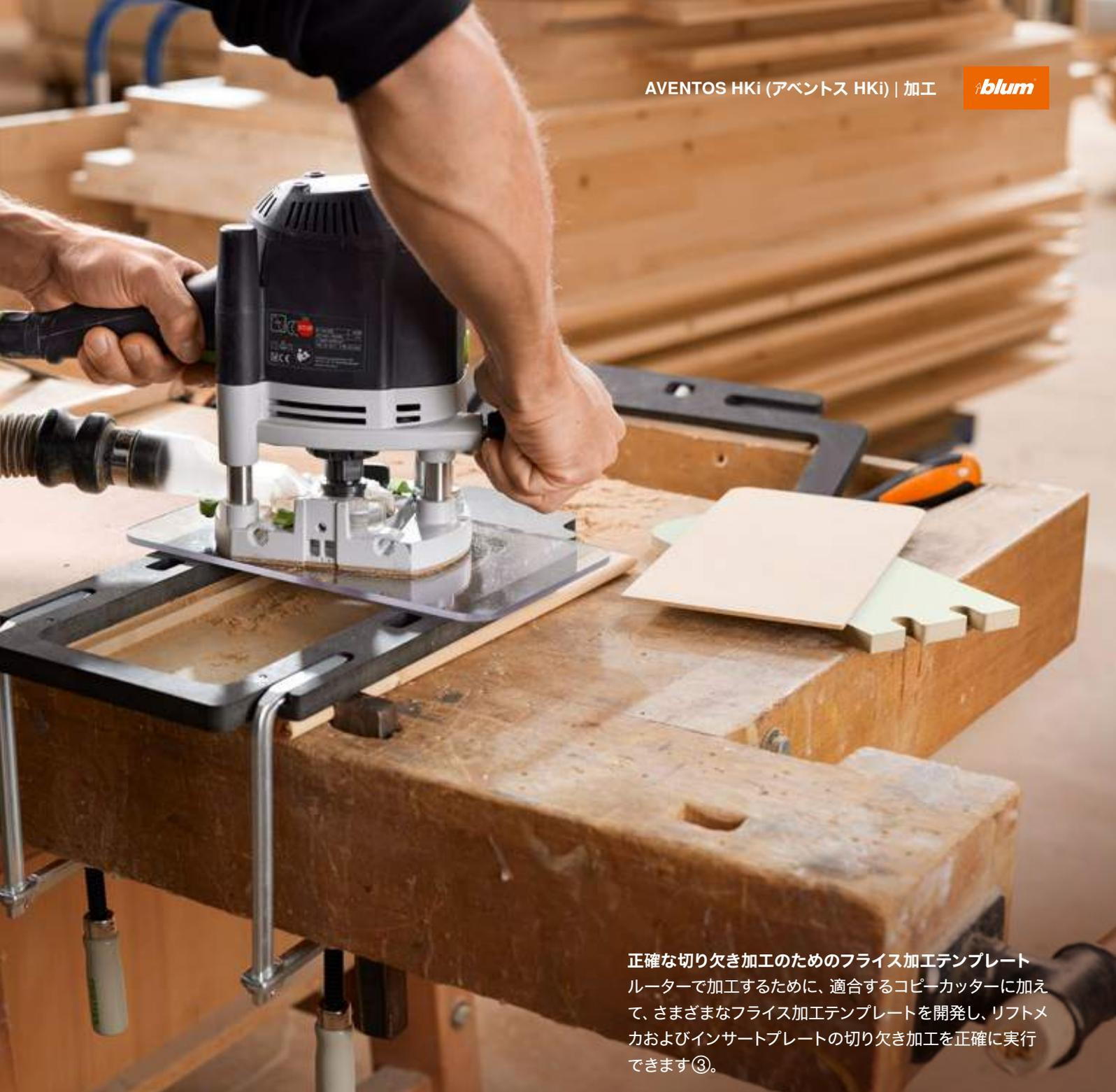
正確な切り欠き加工のためのフライス加工テンプレート
