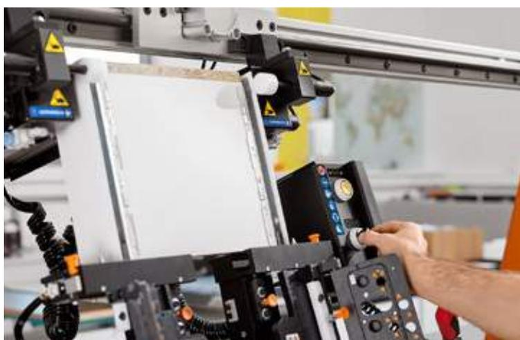
Coloque el fondo, la trasera del cajón y los perfiles. BOXFIX plus fija todos los componentes de forma neumática.
