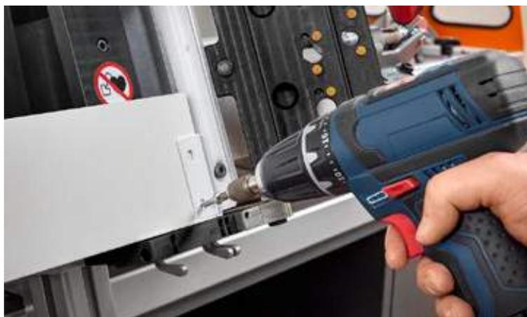
Clave o atornille el adaptador con la trasera de madera.
