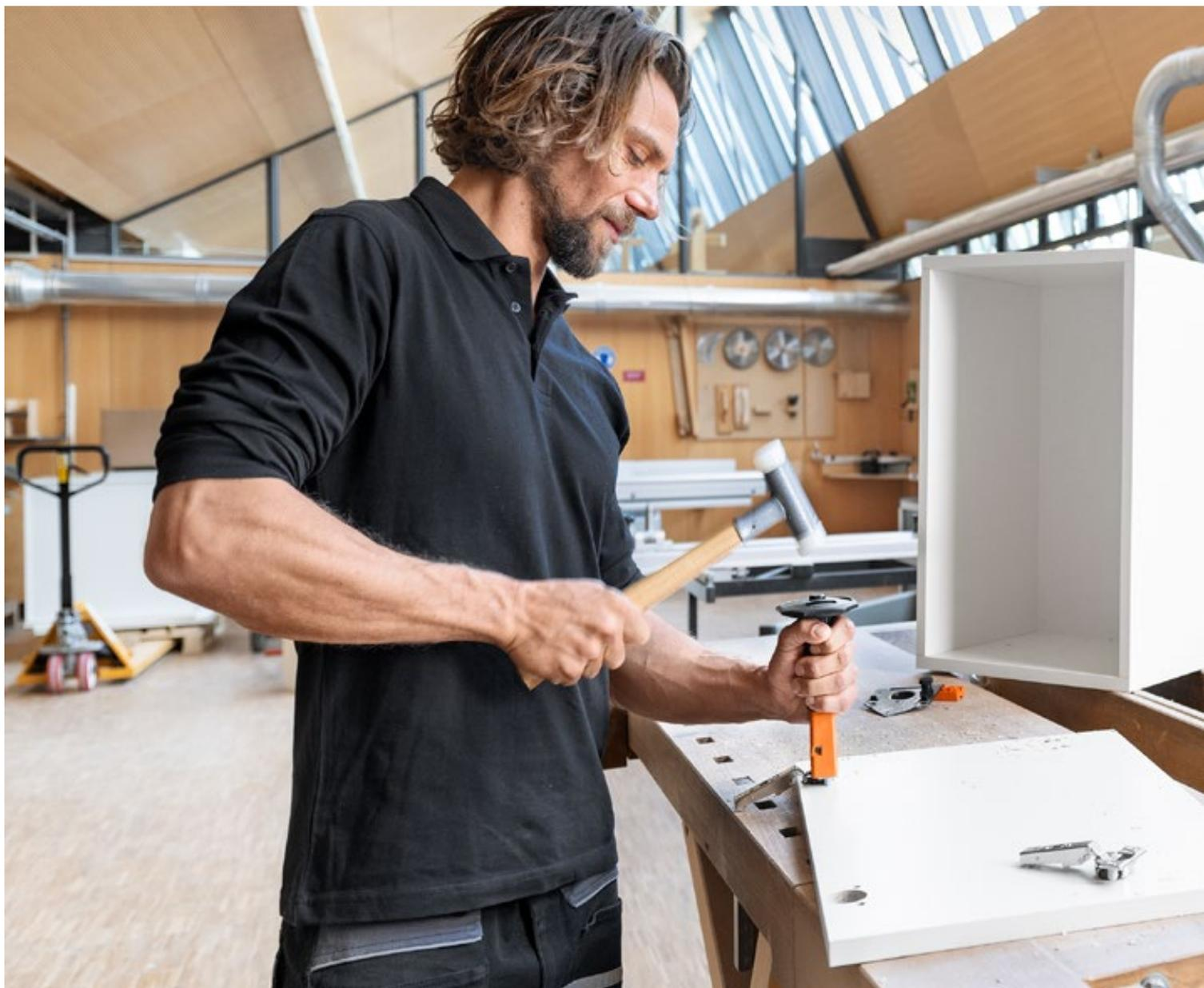
La lavorazione e il montaggio dei nostri sistemi di cerniere si svolgono in modo veloce e semplice. In particolare se utilizzate i nostri attrezzi di lavorazione. Ad esempio nella preparazione del corpo mobile: la bulinatura e la foratura richiedono tempi brevissimi. In questo modo applicate le ante con precisione e senza fatica, risparmiando anche tempo.
