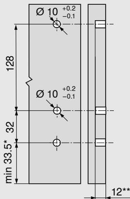
\* + 1 mm en cas de montage de la coulisse corps de meuble avant l'assemblage du corps de meuble
