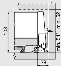
\* + 1 mm en cas de montage de la coulisse corps de meuble avant l'assemblage du corps de meuble
