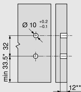
\* + 1 mm en cas de montage de la coulisse corps de meuble avant l'assemblage du corps de meuble
