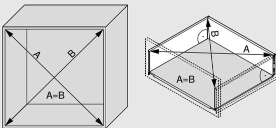
Une production précise est nécessaire pour une jeu de façade de 2.5 mm. Pour cela, respectez les cotes planifiées et l'exactitude des angles.
