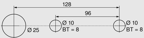
BT Profondeur de perçage
