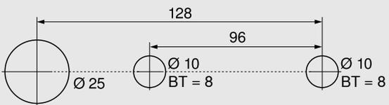
BT Profondeur de perçage
