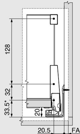
\* + 1 mm en cas de montage de la coulisse corps de meuble avant l'assemblage du corps de meuble
