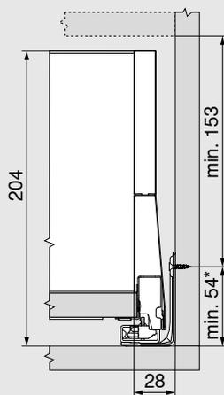
\* + 1 mm en cas de montage de la coulisse corps de meuble avant l'assemblage du corps de meuble
