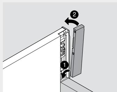
Le cache pour l'adaptateur dos est utilisable avec les dos acier ou bois et est clipsable sans outil sur le côté correspondant.
