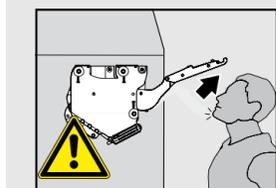
Существует опасность получения травмы при выскакивании рычага!
