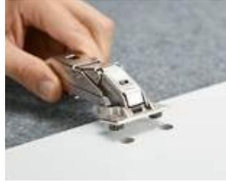
Dübel in die Bohrlöcher setzen ...
