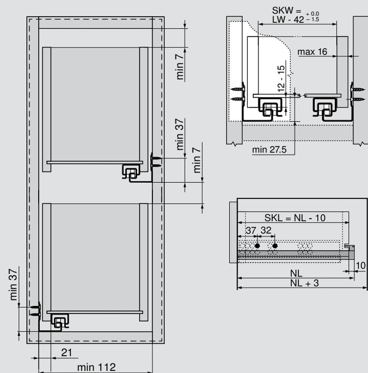
Trabajo del cajón con técnica de acoplamiento
