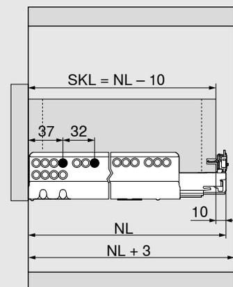
\* Réglage latéral limité avec une épaisseur de côté du tiroir de 16 mm et une utilisation simultanée de toute la tolérance de la largeur intérieure du tiroir
